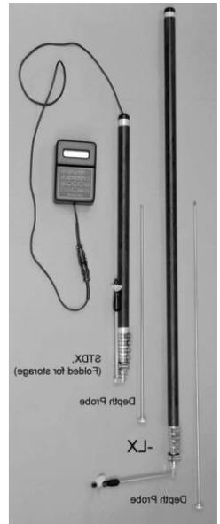
용도 - 하천, 수로 및 실험시설의 유속 측정
